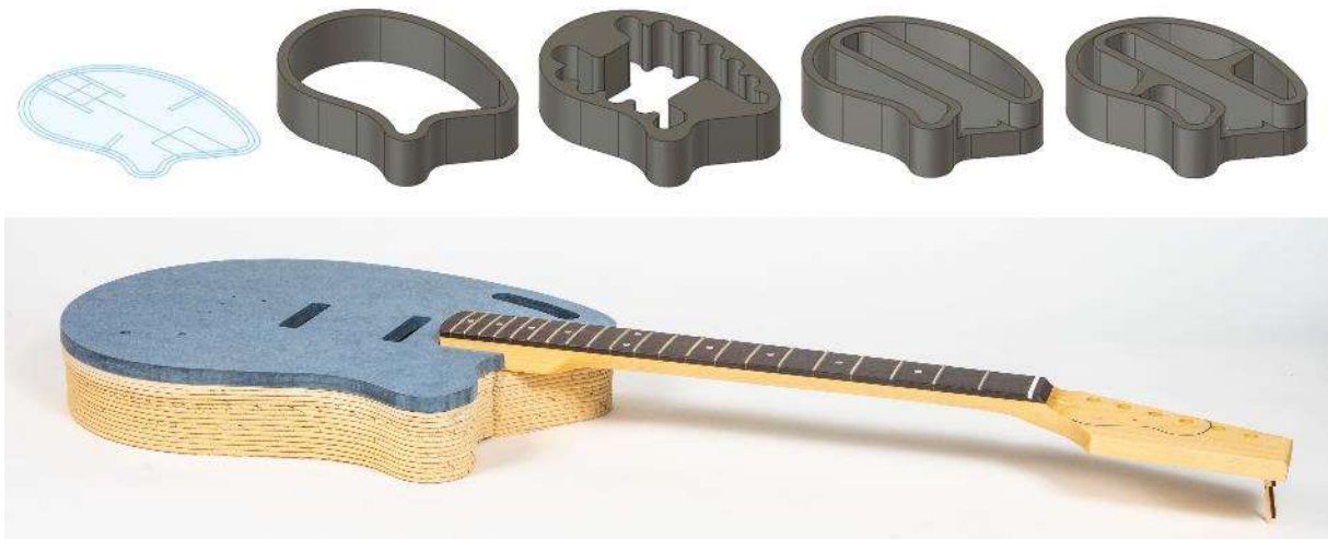
Abb. 7: Materialeffiziente und anforderungsspezifische additive Fertigung einer Gitarrenzarge
