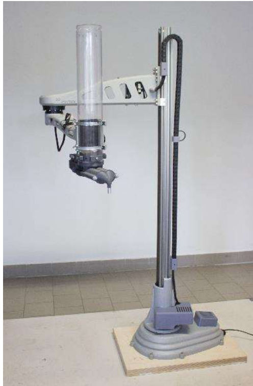
Abb. 2: 3D-Drucker mit selbst entwickeltem Extruder
